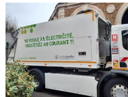
Figure 35 : Benne de collecte à motorisation électrique (VGP)
