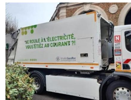
Figure 35 : Benne de collecte à motorisation électrique (VGP)
