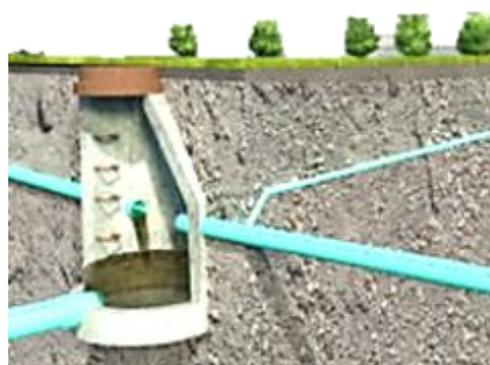
Figure 6: structure d'un regard visible
