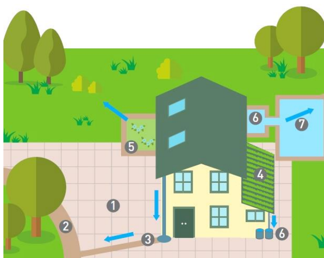
Figure 20: Aménagement pour la gestion des eaux pluviales à la parcelle : exemple 2
